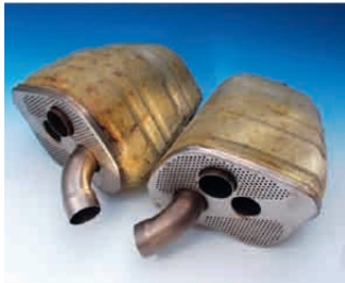
Absorptionskörper aus Basaltwolle
